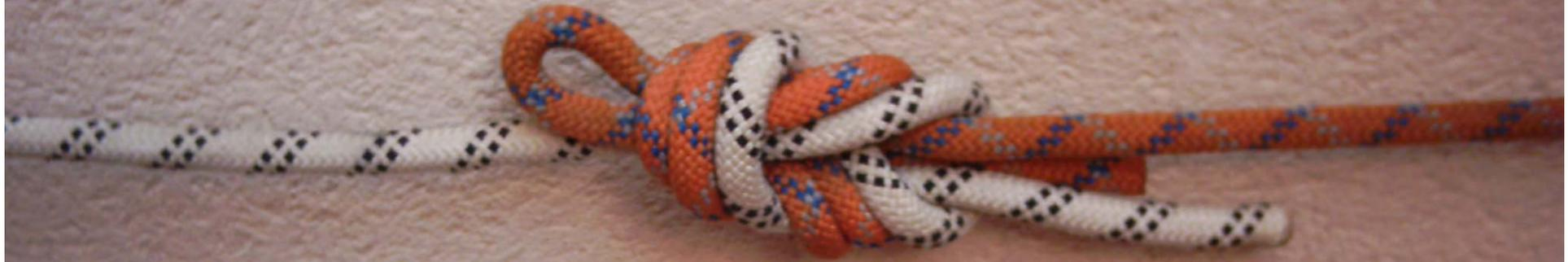
**Será el nudo a utilizar en el empalme de cuerdas. Fácil de hacer y deshacer, requiere poca cuerda para su confección y resiste mas que el nudo de ocho, se puede trenzar con cuerdas de distinto diámetro**
