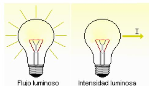
Fig. 7 Diferencia entre flujo luminoso e intensidad luminosa
